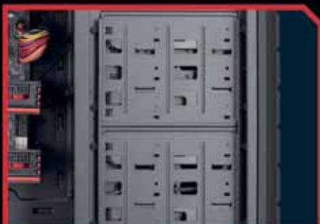
Вентилируемые корзины для HDD с возможностью поворота на 90 градусов для оптимизации охлаждения
